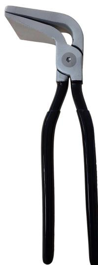
La pince à border coudée à 90° en aluminium garantit un confort de travail sur la durée grâce à un poids réduit de 55% environ versus son équivalente en acier. Elle permet de façonner avec précision tous types de métaux, revêtus ou non. Son angle à 90° facilite la reprise de pli.
