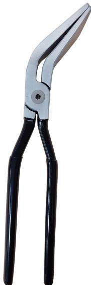
La pince à border coudée à 45° en aluminium garantit un confort de travail sur la durée grâce un poids réduit de 55% environ versus son équivalente en acier. Elle permet de façonner avec précision tous types de métaux, revêtus ou non. Son angle à 45° permet d'accéder aux plis dans des endroits difficiles.
