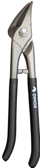
Grâce au passe-franc intégré à sa lame, la cisaille bichantourneuse guide le métal sous la main en sortie de coupe. Elle est idéale pour des coupes droites et courbes à droite. Ses lames de qualité supérieure ne marquent pas le métal et peuvent couper jusqu'à 1 mm d'épaisseur de tôle d'acier.
