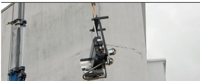
> 2 anneaux de levage pour installation du poste de travail directement sur toiture
