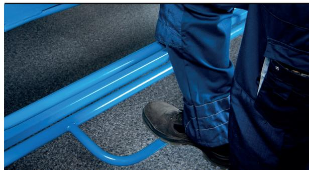
> Sa longueur et sa forme permettent d'actionner le presse-flanc aisément quelle que soit la position de l'opérateur face à la plieuse
