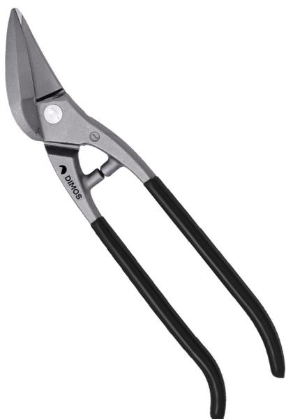
Grâce au passe-franc intégré à sa lame, la cisaille bichantourneuse guide le métal sous la main en sortie de coupe. Elle est idéale pour des coupes droites et courbes à gauche. Ses lames de qualité supérieure ne marquent pas le métal et peuvent couper jusqu'à 1,5mm d'épaisseur de tôle d'acier.
