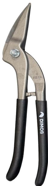
La cisaille pélican est idéale pour une coupe continue et passante sans marquer le métal. Son alliage robuste permet une performance de coupe jusqu'à 1 mm d'épaisseur de tôle d'acier. L'ergonomie des poignées PVC assure une bonne préhension et un grand confort.
