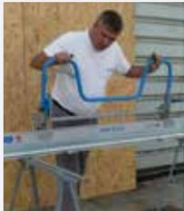
Développée en collaboration avec une ergonome, la poignée ergonomique de la plieuse URBAN® permet un **pliage sans effort** et un **gain de productivité**. Les 2 mains sont utilisées dans une position confortable.
